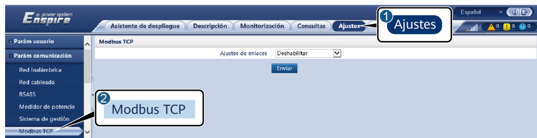
Figura 6-31 Configuración de los parámetros de Modbus TCP
