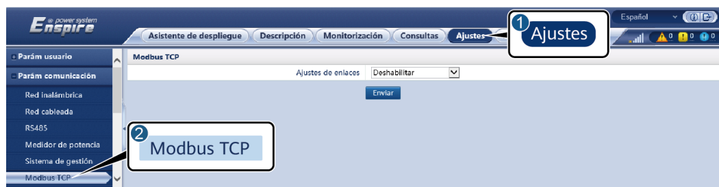
Figura 6-25 Configuración de los parámetros de Modbus TCP
