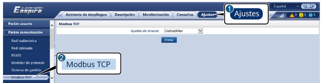
Figura 6-34 Configuración de los parámetros de Modbus TCP
