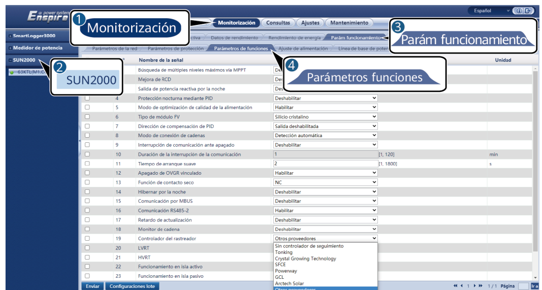
Figura 6-42 Configuración del controlador del sistema de seguimiento
