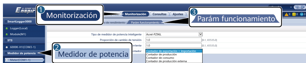
Figura 6-59 Configuración de los parámetros del medidor de potencia
